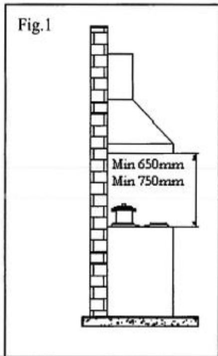
La hotte est munie de tous les accessoires nécessaires à l'installation. **La distance minimale entre le plan inférieur de la hotte et la plaque de cuisson doit être au moins de 750 mm pour les plaques à gaz et de 650 mm pour les plaques électriques** (Fig. 1). **Si l'entrée du moteur est munie d'un clapet de non-retour des fumées, s'assurer qu'il puisse s'ouvrir et se fermer librement.**
