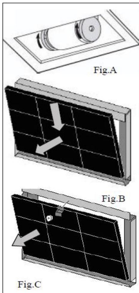
Les filtres au charbon ont la caractéristique de retenir les odeurs **jusqu'au moment où le charbon atteint le niveau de saturation**. Ils ne peuvent pas être lavés, ni régénérés, il est donc recommandé de les remplacer au moins une fois tous les six mois ou plus fréquemment, en cas d'usage particulièrement intensif de la hotte.
